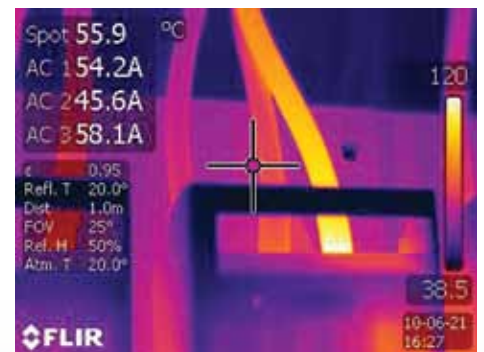
La inspección de unos cables eléctricos revela la existencia de anomalías eléctricas, al examinar unos cables contiguos a unos fusibles protegidos por plexiglás. Gracias a MeterLink, los valores leídos por la pinza amperimétrica se indican en la imagen térmica.
