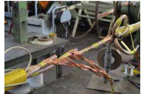
Conectar la maraña enorme de fibras que constituyen al fin y al cabo la totalidad del cable es un trabajo meticuloso en el que los especialistas invierten mucho tiempo.
