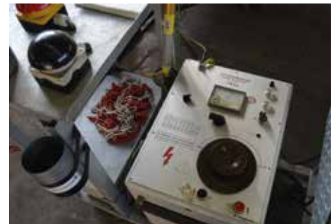
Se utiliza un generador de impulsos de alta tensión para localizar e identificar exactamente los fallos de resistencia alta y baja en los cables de alimentación.
